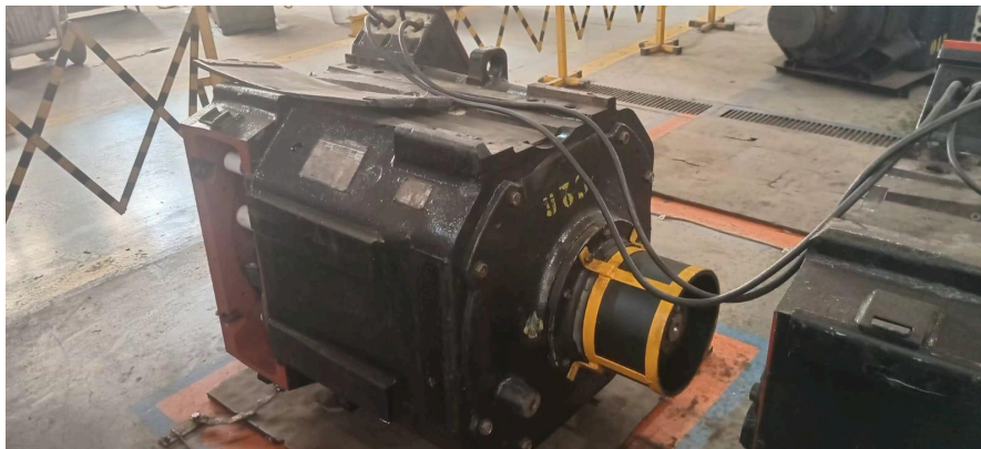
Figura 06: Motor de tração TUE COBRASMA Metrô BH.
